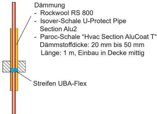
Um die Rohrschale wird ein Streifen der UBA-Flex fixiert. Damit werden die im Brandfall entstehenden Bauteilbewegungen ausgeglichen. Zudem entfallen Drahtumwicklungen um die Rohrschale oder andere Einschränkungen.
