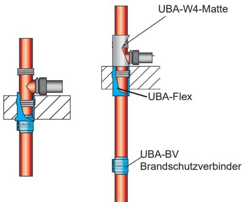
Der UBA-BV Brandschutzverbinder wird wie ein Regelverbinder montiert. Durch diese schnelle Montage entsteht kein zusätzlicher Montageaufwand.
