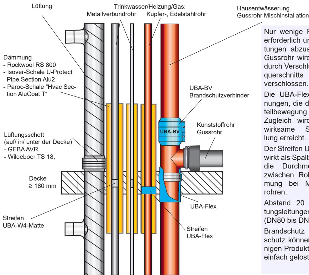
Nur wenige Produkte sind erforderlich um die Rohrleitungen abzuschotten. Das Gussrohr wird im Brandfall durch Verschluss des Rohrquerschnitts im UBA-BV verschlossen.
