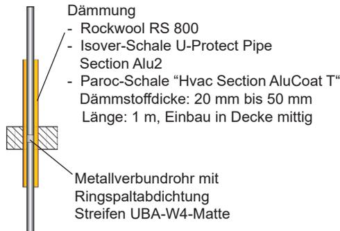
Wenn der Innendurchmesser der Rohrschalen (Dämmung) größer ist als der Rohraussendurchmesser, ist der daraus resultierende Ringspalt abzudichten. Bei UBA-UNI wird im Bereich der Deckendurchführung ein Streifen der UBA-W4-Matte H= 50 mm fixiert.
